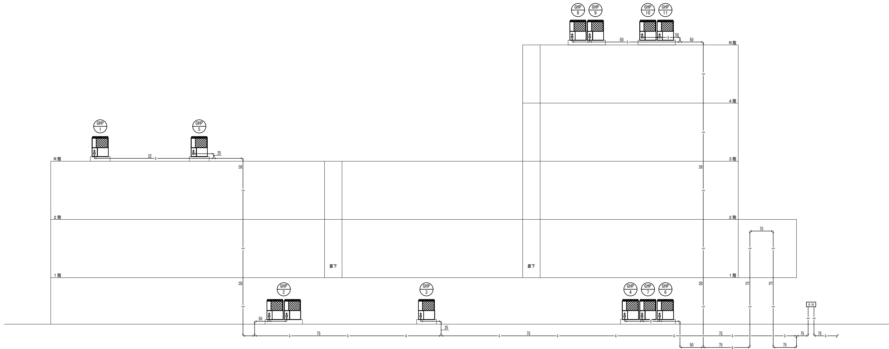
校舎棟 都市ガス設備 系統図
