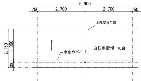
自転車置場 平面図 1/100 駐輪場 設計GL=平均地盤面
