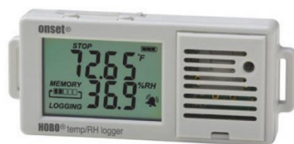
図 2-1 屋内温湿度の計測に使用した測器 （HOBO UX100-003 温度／湿度ロガー 2 ）
