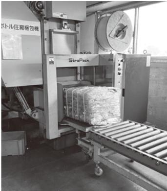
写真は、「川角リサイクルプラザ」のペットボトル圧縮梱包機です。集められたペットボトルは、この機械を通して圧縮・梱包(ベール化)。1つの梱包の重さは約15kgになります。この後、ペットボトルや卵のパック、洋服などに生まれ変わるため、(公)日本容器包装リサイクル協会を通して、リサイクル工場へ運ばれて行きます。
