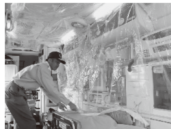
ビニール製カーテンで覆った救急車内
