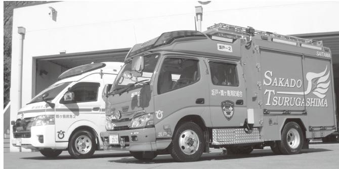
坂戸2号車は、今回から600ℓの水槽およびCAFS(圧縮空気泡消火装置)を搭載しています。
